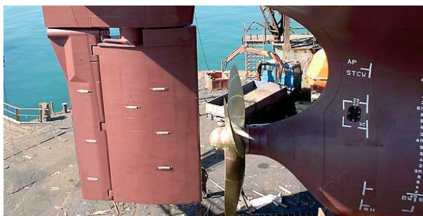
I.3.18 pav. Vairas su antvairiu, kurio posūkis plaukiant mažu greičiu galimas iki 75^\circ (Becker marine system).
