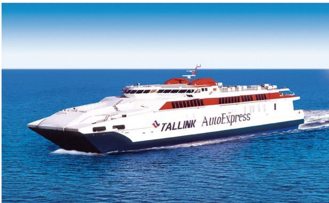
I.4.9 pav. Greitaeigis Ro-Ro keltas-katamaranas, talpinantis iki 50 automobilių ir iki 300 keleivių, greitis iki 60 mazgų.
