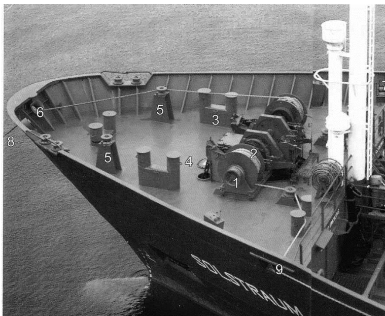
I.6.19 pav. Tanklaivio laivapriekio švartavimo elementai
