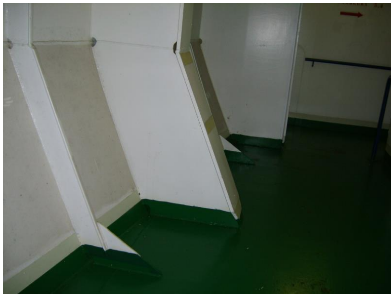
I.5.8 pav. Laivo borto ir denio jungimo vieta (paprastas ir rėminis špangoutai bei knicos) laive „LISCO OPTIMA“
