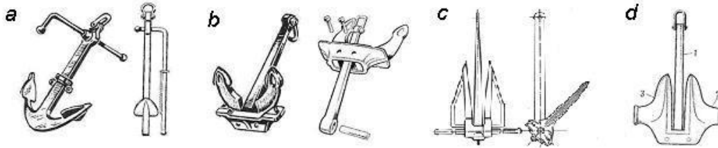
I.6.13 pav. Inkarų tipai a – Admiraliteto, b – Holo, c- Danforto, d – Matrosovo
