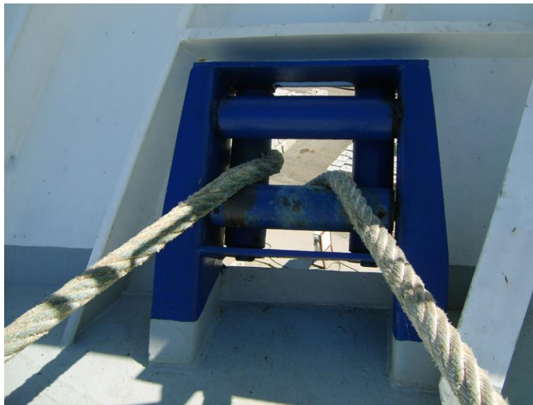
I.5.22 pav. Kliuzas su roulsais, sujungtas su laivo korpuso konstrukcija (laive LISCO OPTIMA)
