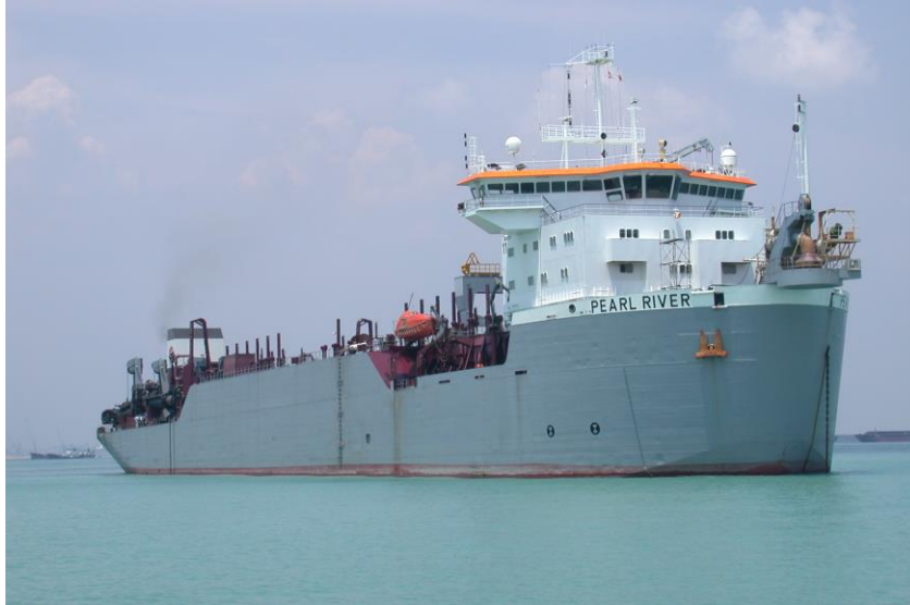
I.4.3 pav. Šiuolaikinė žemsiurbė, turinti antstatą laivo priekyje ir mašinų skyrių laivagalyje (grunto talpa 30000 m 3 )
