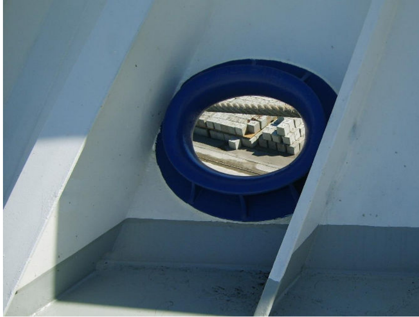
I.5.21 pav. Kliuzas falšborte (laive LISCO OPTIMA), šalia rėminis ir paprastas špangoutai.
