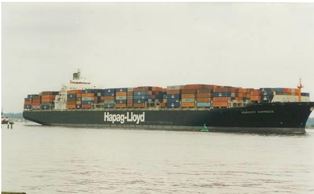
I.4.7 pav. Konteinerių vežimo laivas, turintis laivo antstatą ir mašinų skyrių laivo viduryje.
