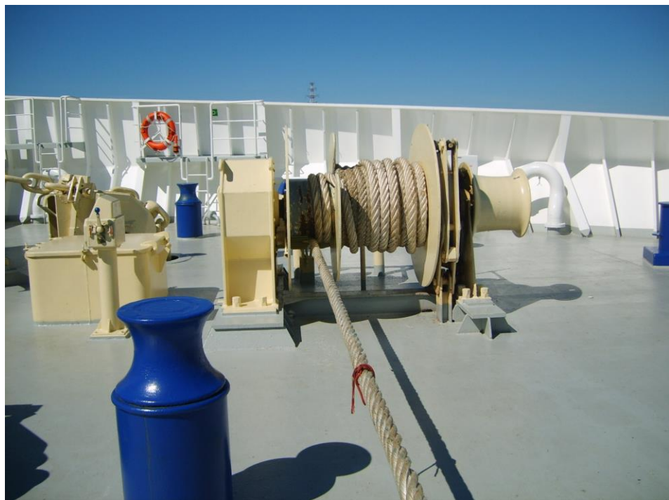
II.4.11 pav. Automatinė švartavimo gervė Ro-Ro laive LISCO OPTIMA.
