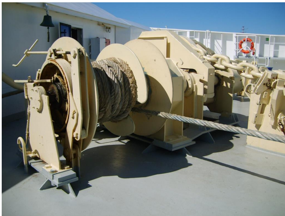
II.4.8 pav. Kombinuotas švartavimo mechanizmas (automatinė švartavimo gervė su inkariniu mechanizmu) (Ro-Ro laivas LISCO OPTIMA)
