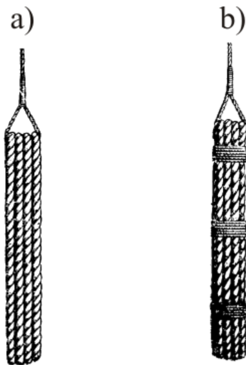
II.2.64 pav. Atmušo iš trosų gamyba.
