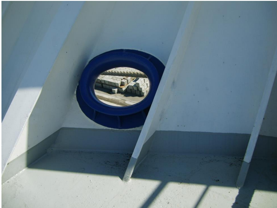
II.4.2 pav. Tipinis švartavimo kliuzas be besisukančių dalių.
