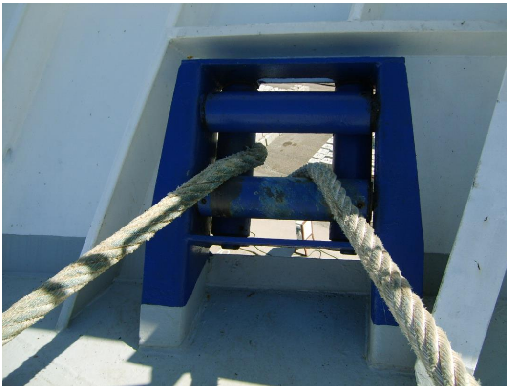
II.4.4 pav. Padidintos laikymo jėgos kliuzas su besisukančiais elementais (roultais).
