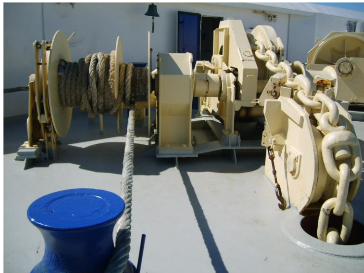
II.3.17 pav. Kombinuotas inkarinis įrenginys (Ro-Ro keltas LISCO OPTIMA)
